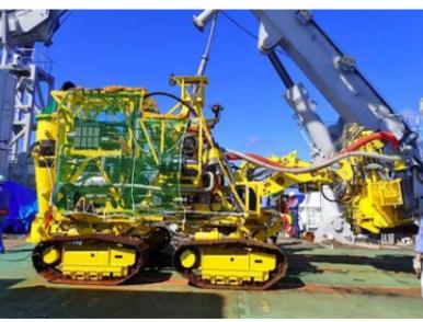
掘削機(熱水鉱床用掘削機を改良)
